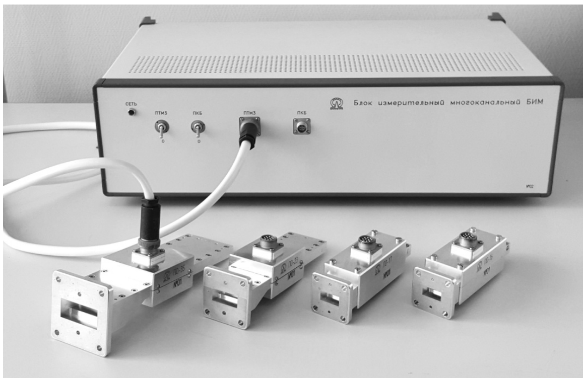
Рисунок 67 — Эталон переносчик с комплектом преобразователей мощности оконечного типа и блоком измерительным
