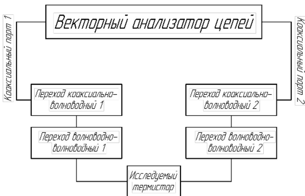
Рисунок 8 — Блок-схема установки измерений модулей и фазы коэффициента отражения и передачи термистора
